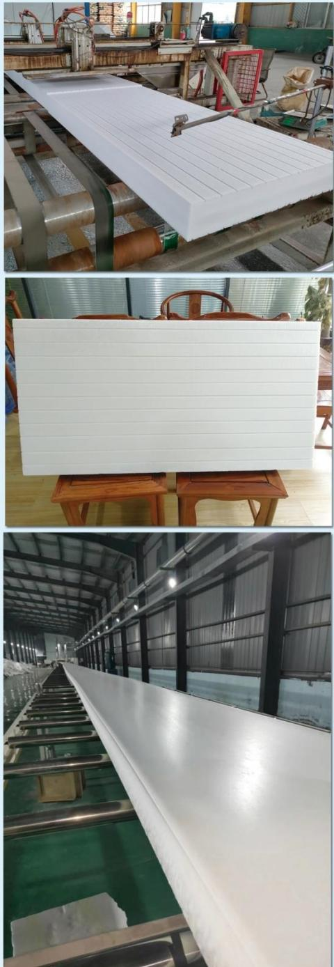
XPS挤塑聚苯板特有的闭孔式蜂窝结构，使其具有低吸水率，低热导系数，而且XPS挤塑聚苯板本身没有吸水性，所以基本不可能出现老化现象。
