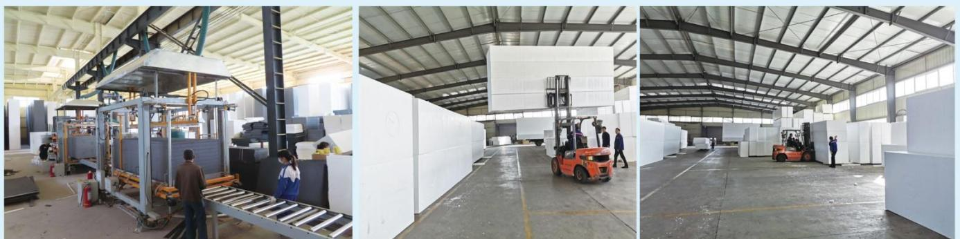
本厂采用联合国环境署推荐的二氧化碳发泡工艺，取代传统的氟利昂发泡工艺，减少氟利昂对臭氧层的破坏。
